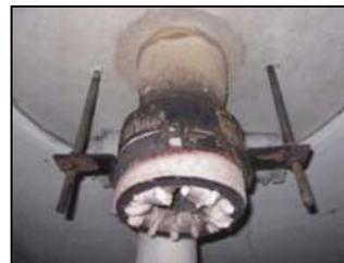
耐火試験後のS型モエナイン（延焼防止材）
