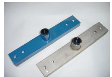
写真1:脚部継手吊下げ施工治具 LEJ(防振ゴム付) 左:SS400製 エポキシ樹脂コーティング 右:SUS304製
