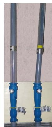
加振時、5°変位した状態での満水試験状況
