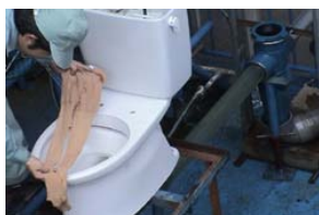
CPジョイント内部での ④パンティーストッキング通過状況
