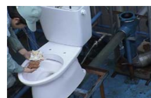
CPジョイント内部での ⑥みそ&トイレトペーパー通過状況
