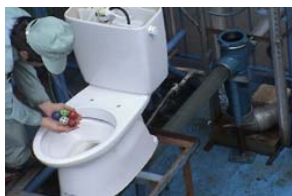
CPジョイント内部での ①練習用ゴルフボール通過状況
