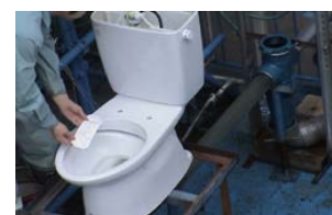
CPジョイント内部での ③生理用ナプキン通過状況
