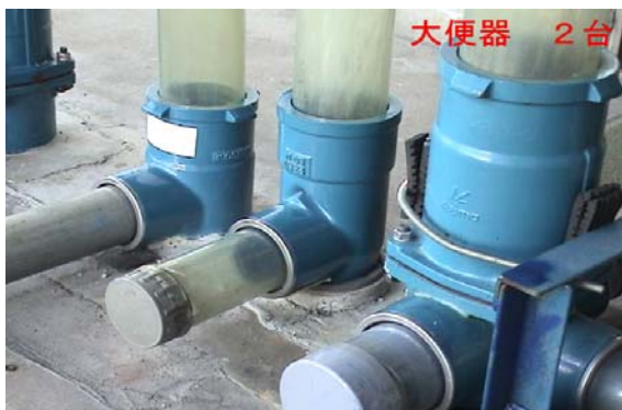
KST横枝管への流入状況 (分流ガイドの効果)
