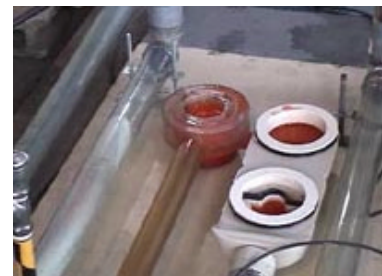
横枝管の洗浄を行っている ときのトラップ封水変動
