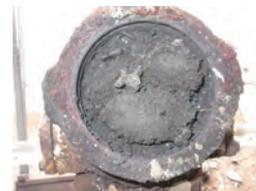
火災時に延焼防止材が管路を閉塞。上階への熱や炎・煙の侵入を防ぎます。
