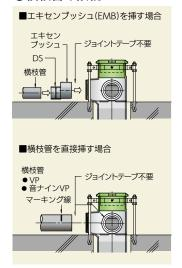
横枝管受け口にはVP管、音ナイ ンVP、エキセンブッシュを接続 できる。横枝管は、予め記したマ -キング線(管端から58mm)の位 置まで挿入する。
