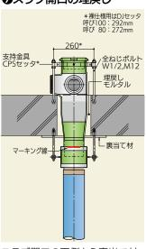
スラブ開口の下側から裏当て材 を当てて、モエナインSCPと開口 部との隙間にモルタルを充填す る。裏当て材はモルタルが硬化 後取り外す。
