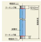
裸管部(上)に呑込代(呼び径100: 65mm、75:55mm)をマーキング する。裸管部(下)に呑込代(呼び径 100、75とも:65mm)をマーキン グする。
