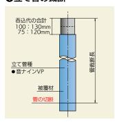
立て管(音ナインVP)の被覆材を、 一方の端面から上下の呑込代の 合計分(呼び径100: 130mm 75: 120mm) だけ片側にスライ ドさせ、裸管側の管端から菅裁断 長の位置で被覆材ごと切断する。
