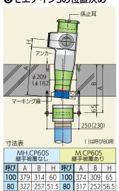
モエナインSのパッキンと継手下部 直管部にシール性滑剤を均一に塗 り、継手下部端面から65mmの位 置に引いたマーキング線の位置ま で挿入し、接続する。
