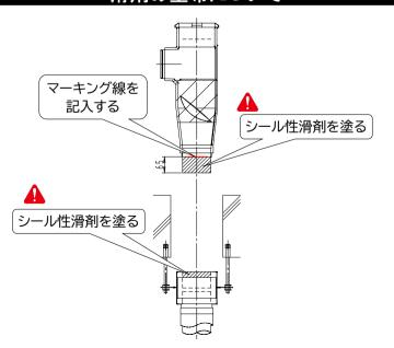
継手下部直管部とモエナインSの ゴムリング内面にシール性滑剤を 塗って接続してください。
