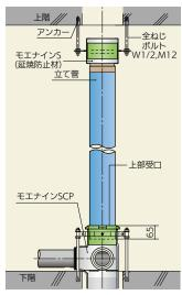
立て管を直立させ芯出しを行った 後、立て管上端部に取り付けた延 焼防止材を、スラブ下面に設けた アンカーから全ねじボルトで係止 する。
