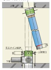
下階のモエナインSCPの上部受 口と、立て菅の裸管部(下)に COREソープを均一に塗布し、 - -マーキング線が隠れるまで挿入
