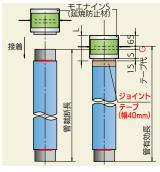
モエナインSのソケット内面と裸管 部(上)の外周面に接着剤を塗ってか ら、マーキング線まで挿入接着する。
