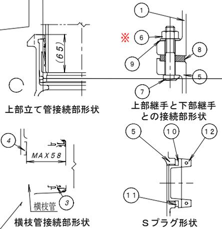
※ 上部継手と下部継手は、それぞれの横枝管接続口の向きが、品番・呼びに示された位置関係になるように、相互に嵌合させたキーによって、位置決めされボルト・ナットで固定されています。
