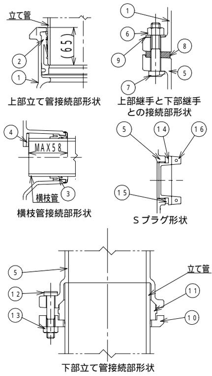
上部継手と下部継手は、それぞれの横枝管接続口の向きが、品番・呼びに示された位置関係になるように、相互に嵌合させたキーによって、位置決めされボルト・ナットで固定されています。
