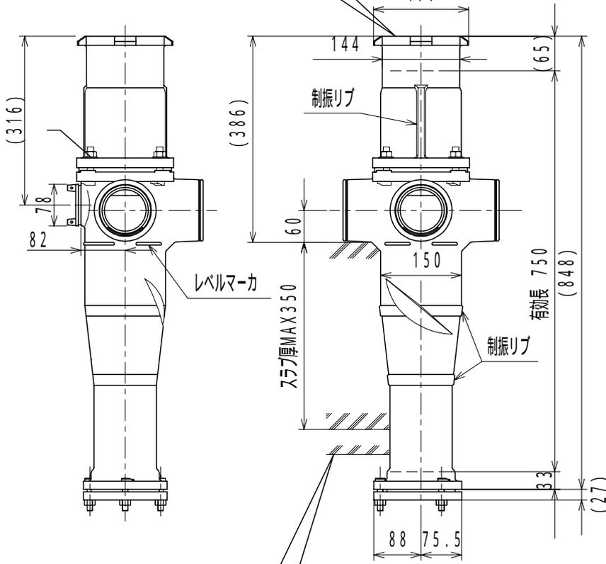
T ボルトを下から挿入した場合、スラブ厚は最大 300 mm まで対応可能です。なお、KR フランジ (T ボルト落下防止、T ボルト回り止め仕様) の場合もスラブ厚最大 300 mm まで対応可能です。
