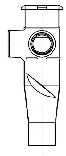
※2 継手下部直管部とモエナインSのゴムリング内面にシール性消剤を塗って接続して下さい。
