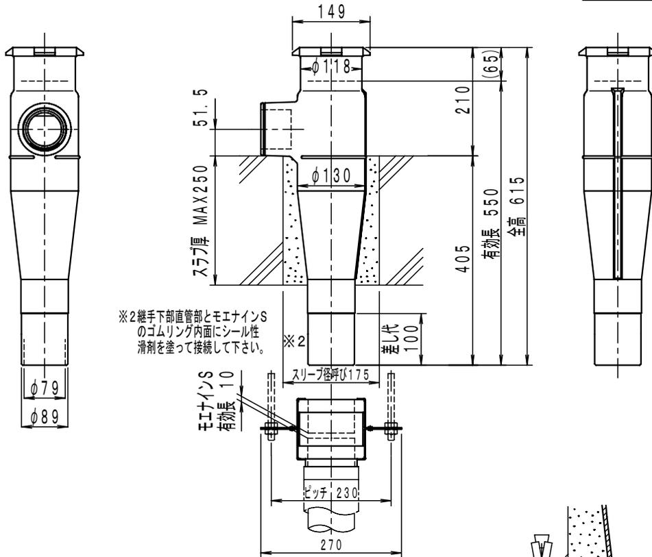
※2継手下部直管部とモエナインSのゴムリング内面にシール性滑剤を塗って接続して下さい。
