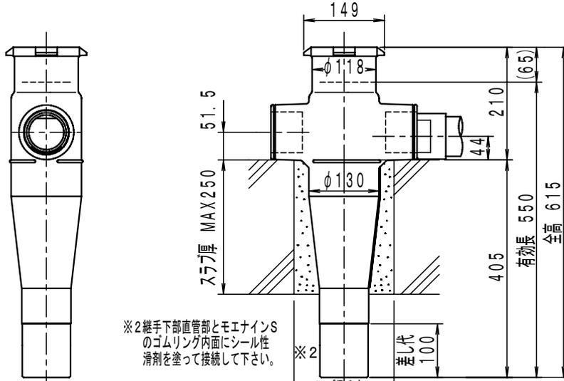
※2 継手下部直管部とモエナインSのゴムリング内面にシール性滑剤を塗って接続して下さい。
