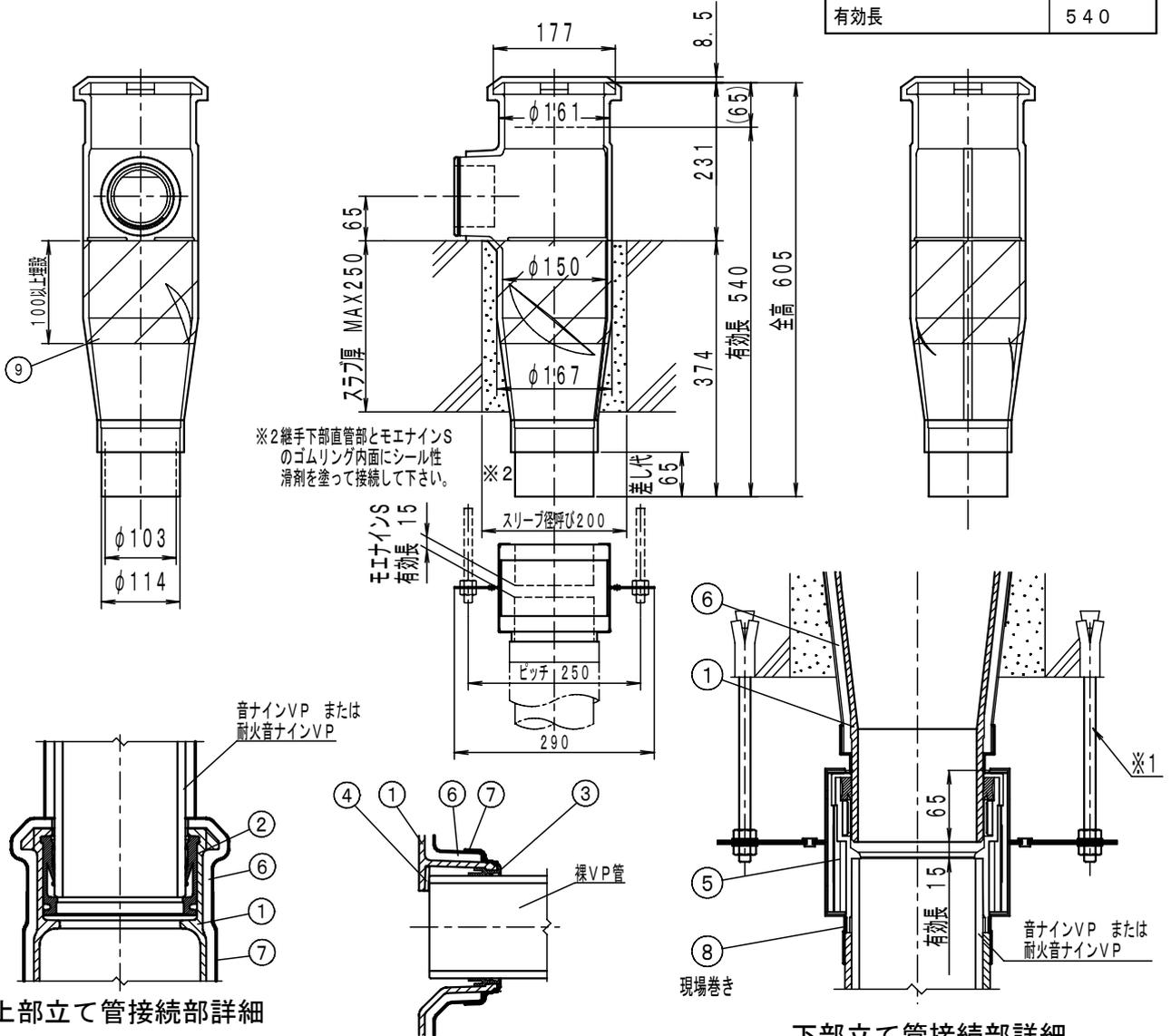
※2 継手下部直管部とモエナインSのゴムリング内面にシール性清剤を塗って接続して下さい。
