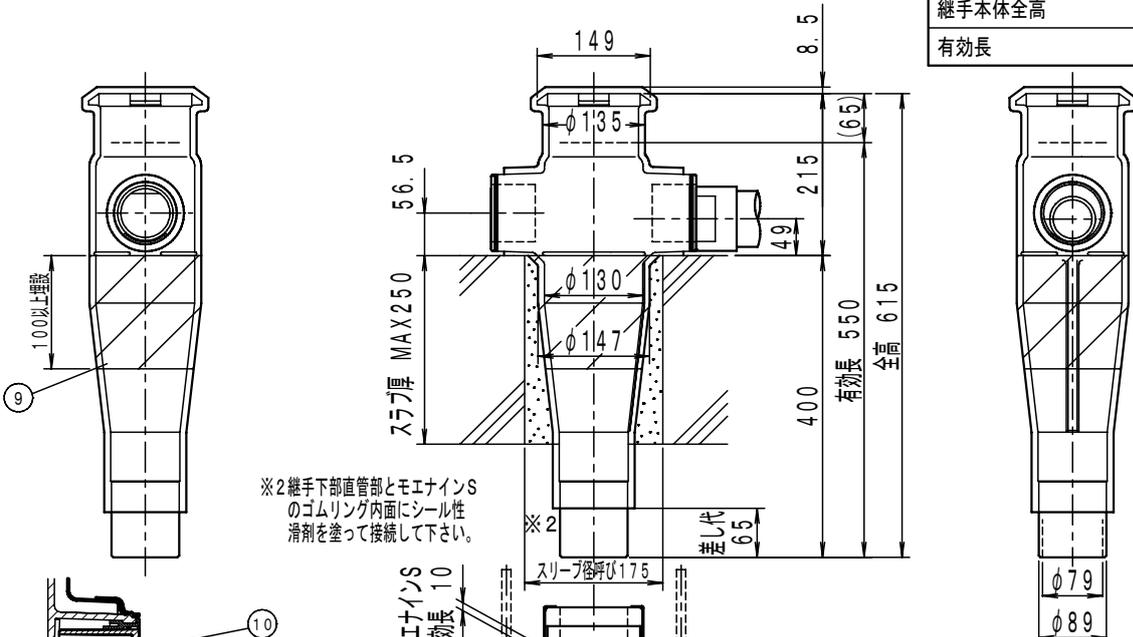
※2 継手下部直管部とモエナインSのゴムリング内面にシール性滑剤を塗って接続して下さい。
