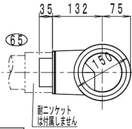
見え掛かりの部分については、0.6mmのステンレス鋼板で被っていますので、硬質塩化ビニル管等の防火区画等の貫通に関する法令等に準じています。
