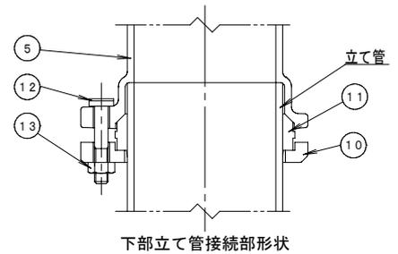
※1 上部継手と下部継手は、それぞれの横枝管接続口の向きが、品番・呼びに示された位置関係になるように、相互に嵌合させたキーによって、位置決めされボルト・ナットで固定されています。
