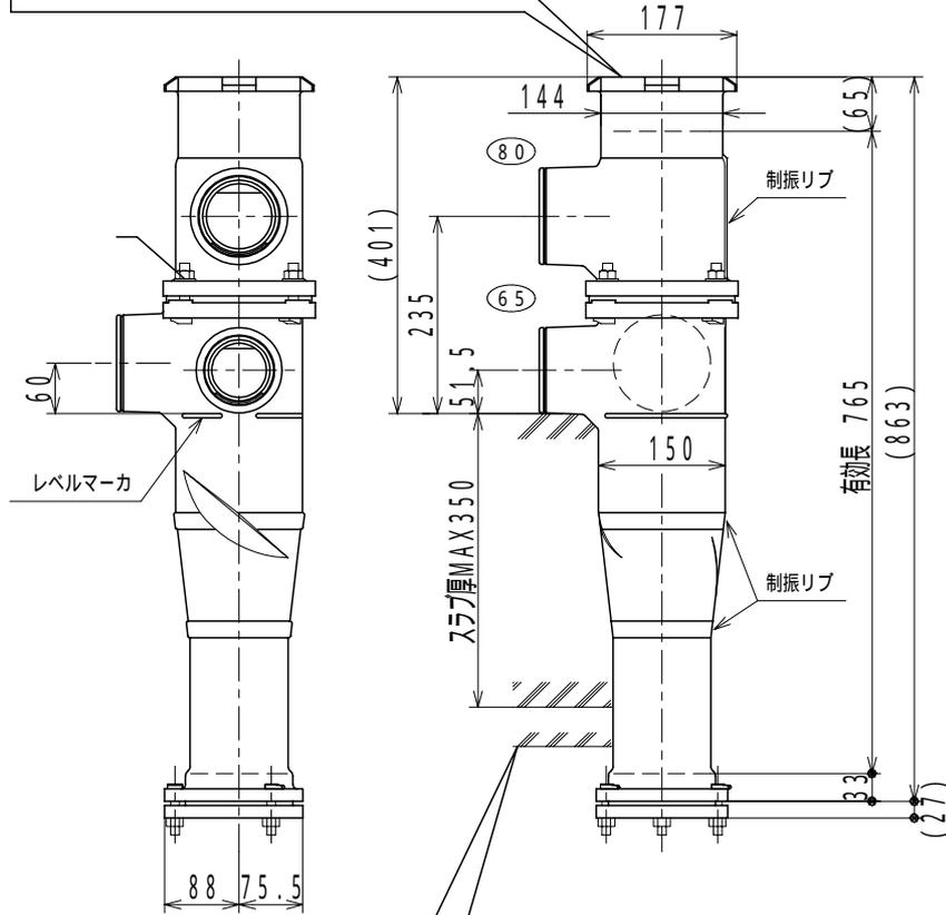
Tボルトを下から挿入した場合、スラブ厚は最大400mmまで対応可能です。なお、KRフランジ（Tボルト落下防止、Tボルト回り止め仕様）の場合もスラブ厚最大400mmまで対応可能です。
