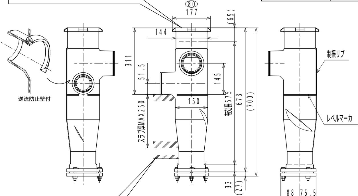
T ボルトを下から挿入した場合、スラブ厚は最大 300 mm まで対応可能です。なお、KR フランジ (T ボルト落下防止、T ボルト回り止め仕様) の場合もスラブ厚最大 300 mm まで対応可能です。
