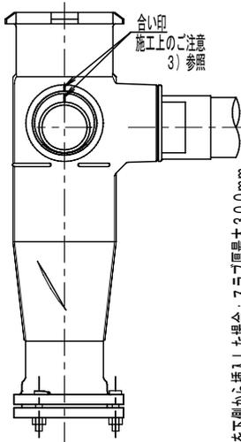
Tボルトを下側から挿入した場合: スラブ厚最大300mm
